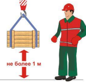
Приближаться к спускаемому (поднимаемому) грузу разрешается только при расстоянии от груза до земли не более 1 м
